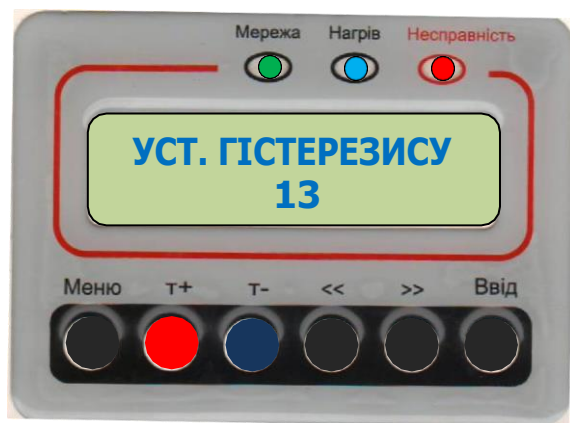
Рис. 11 Вид панелі управління при установці температурного гістерезису
