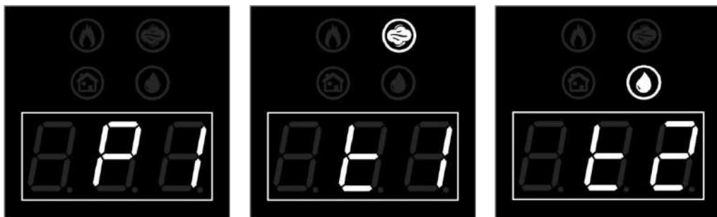
Рисунок 5 — Выбор режима контролирования
