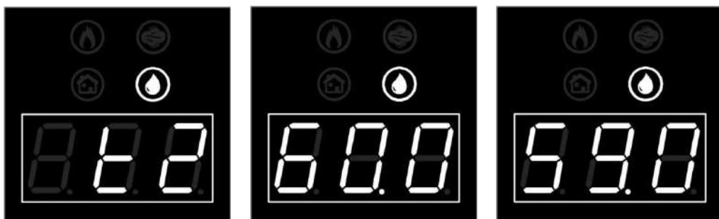
Рисунок 3 — Настройка границ температуры теплоносителя
