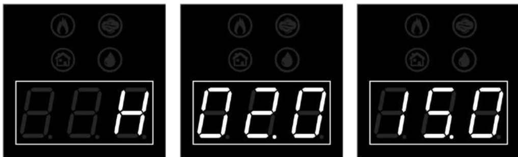
Рисунок 8 — Установка пауз включения и выключения насоса
