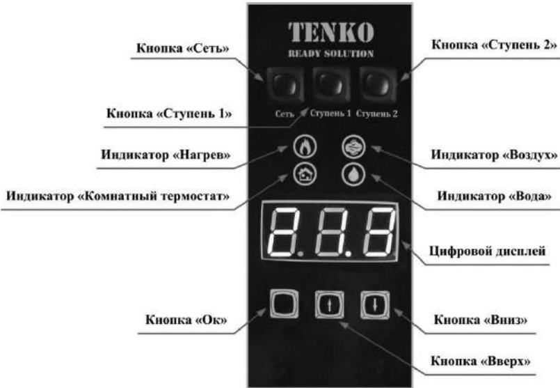
Рисунок 1 — Панель управления котла Tenko Digital
