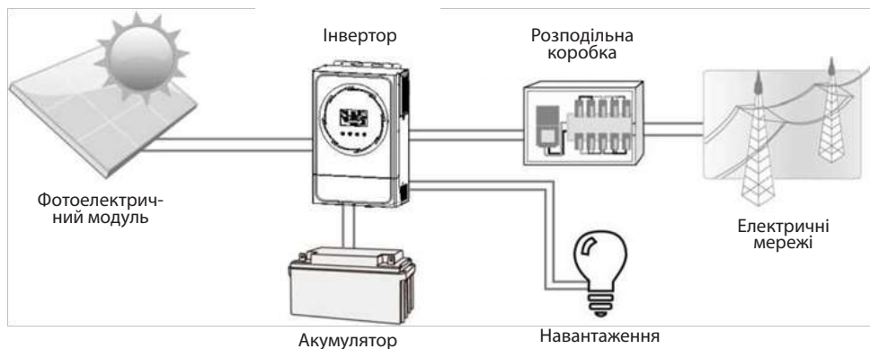
Малюнок 1 Загальний огляд фотоелектричної системи
